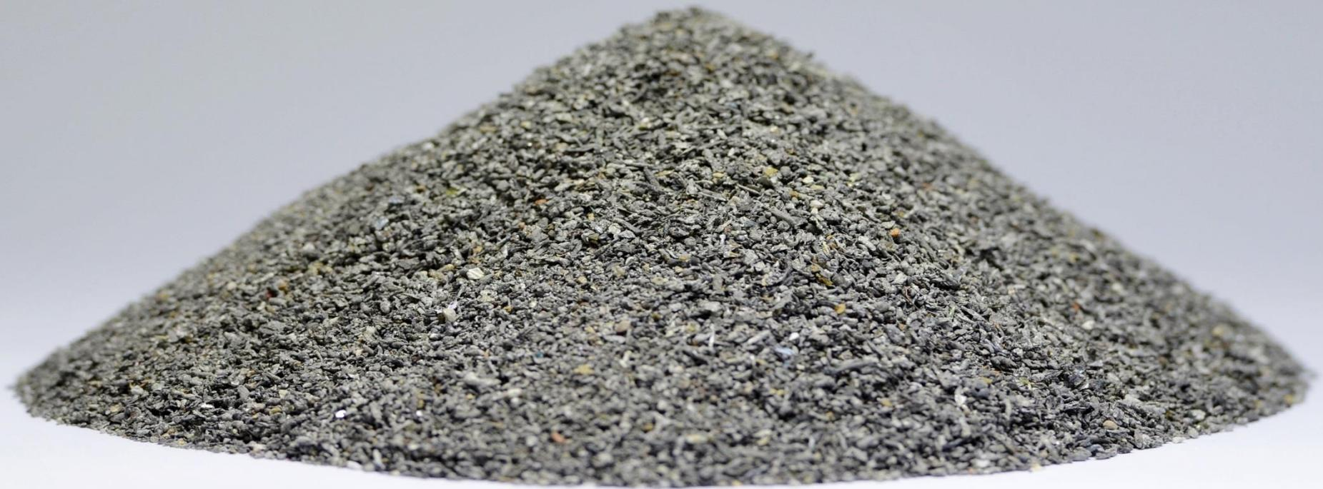
**feines Aluminium nach Schlackenaufbereitung (0.3 – 1.2 mm)**
